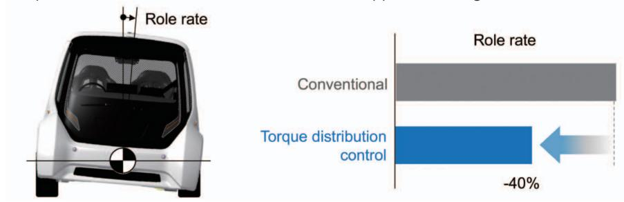
• Smart SBWS を左右に傾けるだけの新たな操縦性を提供
