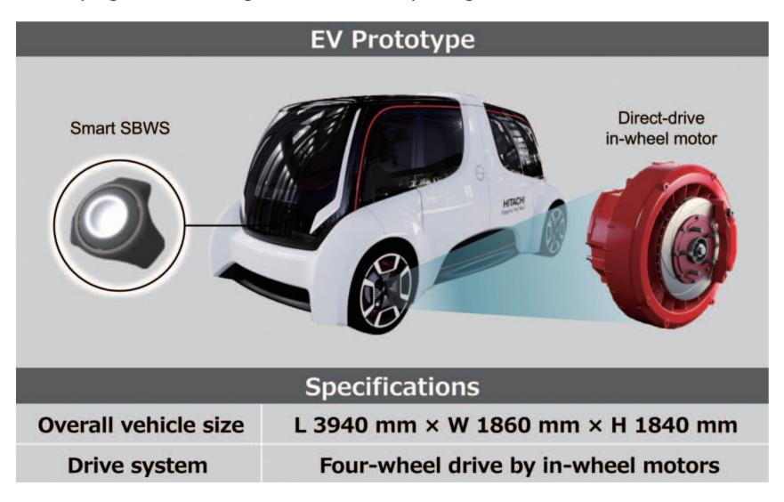
・ダイレクト駆動モーターのトルク分配制御によりロール運動を抑制
