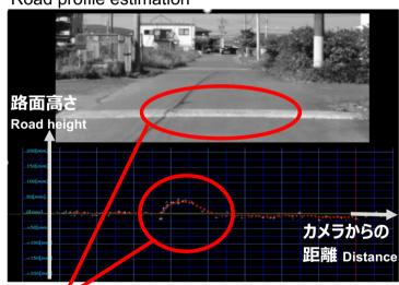
前方のスピードバンプと検知結果 Speed bump and its detection result
