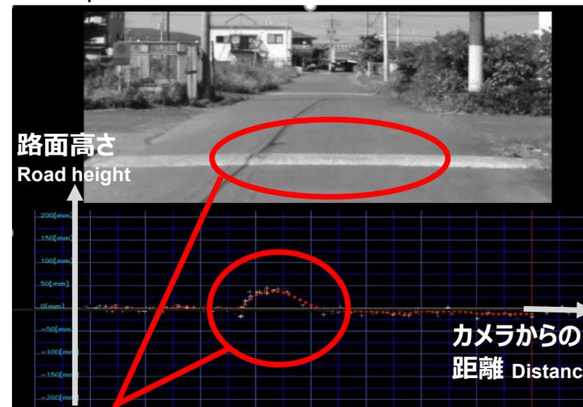
前方のスピードバンプと検知結果
