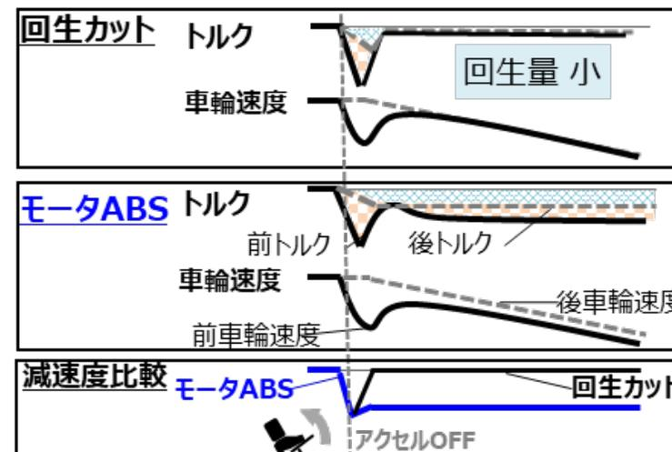
前輪のスリップ状態から推定した路面 $\mu$ 情報に基づいて後輪トルクを制限することで、車両安定性と回生効率を両立
